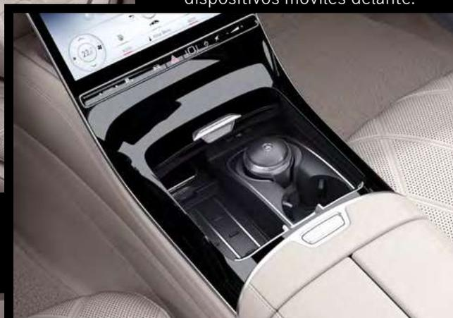
Sistema inalámbrico de carga para dispositivos móviles delante.
