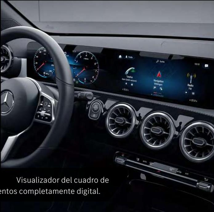
Visualizador del cuadro de instrumentos completamente digital.
