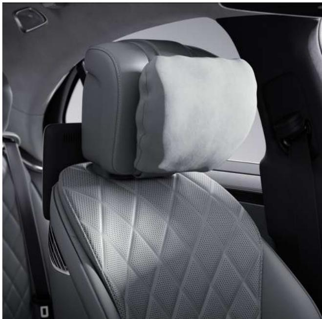
Reposacabezas de confort EASY ADJUST para conductor y acompañante, abatible en el lado del acompañante.
